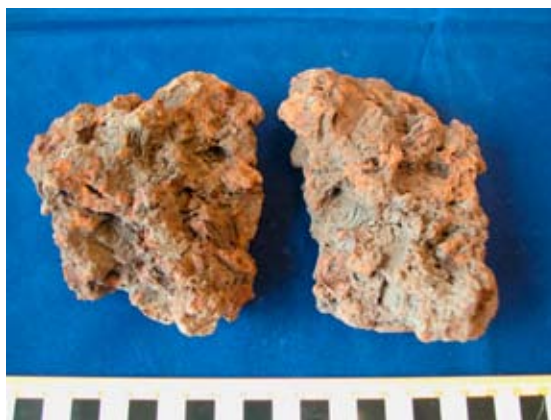
Fig. 2. Trögfluten slagg, F76, med rikligt med kolavtryck och hålrum. Foto: Lena Grandin.
