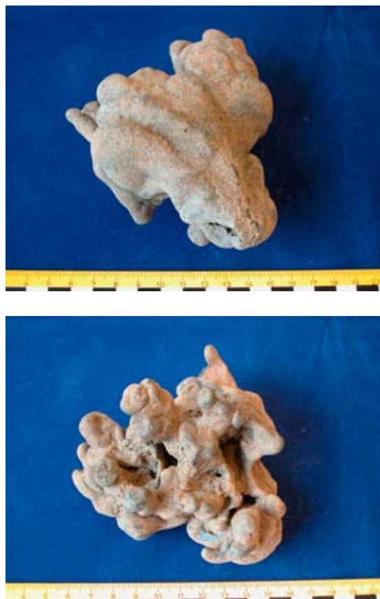
Fig. 4. Stearinformat slag, F88. Översidan respektive undersidan där de enskilda slagsträngarna är tydligt urskiljbara. Foto: Lena Grandin.
