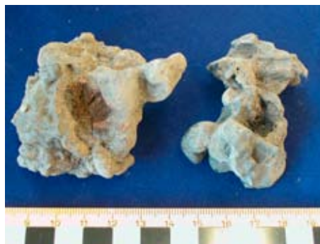
Fig. 26. Stearinslagg med träkolsbitar. Foto: Lena Grandin.
