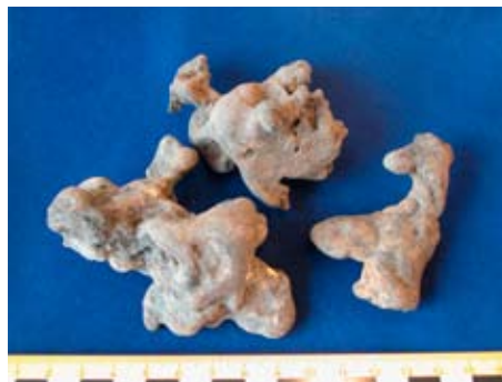
Fig. 25. Små strängar av stearinslagg. Foto: Lena Grandin.
