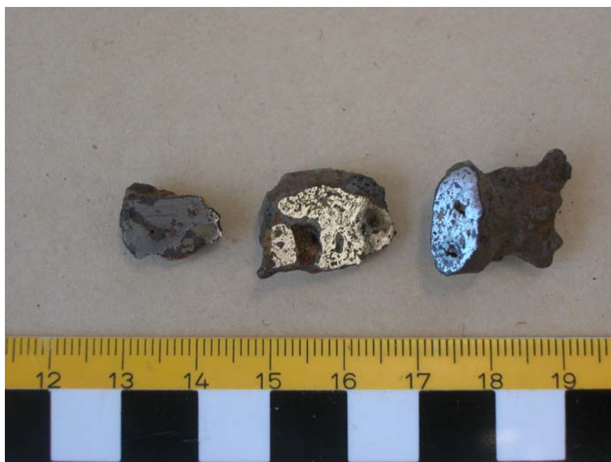
Figur 1. Tre metallklumpar, Fnr 154, 149 och 21 från vänster till höger, vilka snittats för att undersöka förekomsten av metalliskt järn. Samtliga tre prover består till största delen av metalliskt järn omgärdat av slagg.
