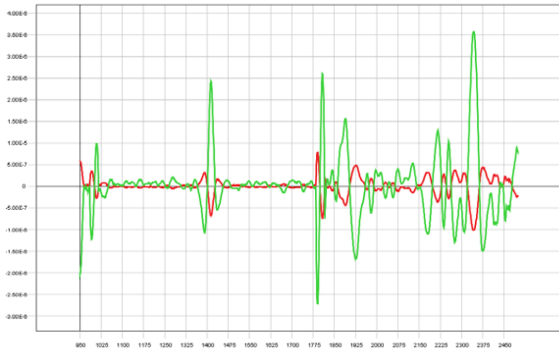
Figur 11. Savitzky-Golay filtering av NIR data. Negativa toppar är de relevanta. Spektral respons för prover inom K1000 (grön linje) och prover utanför (röd linje).
