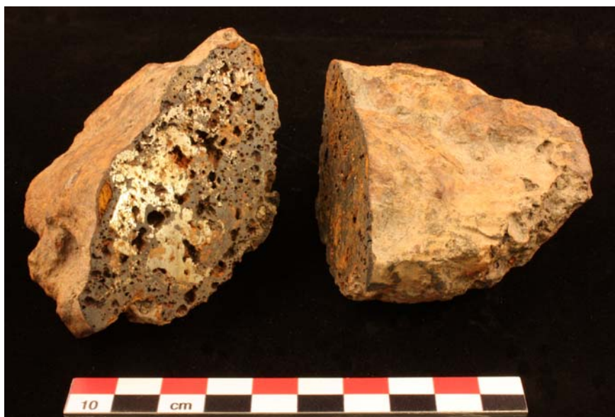
Figur 1. Järnklump med slagg från Garn som har delats på mitten. Järnet syns tydligt med sin fina glans. Hela stycket innehåller en hel del hålrum.
