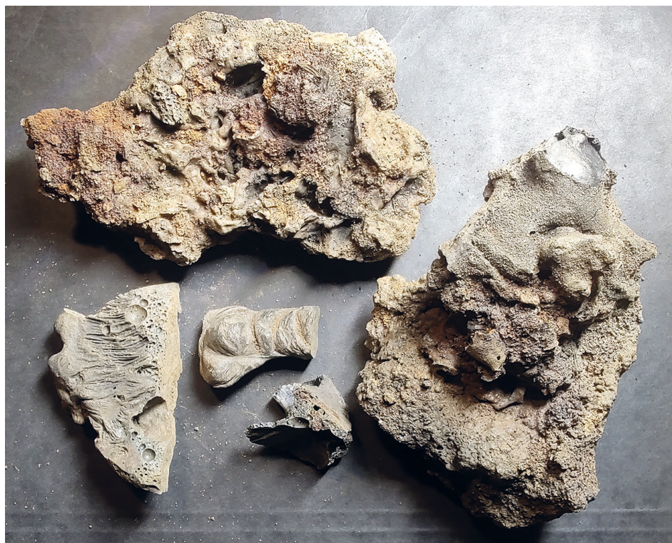
FIGUR 24. Ett urval av den slagg (F11) som samlades in från A1016 (L2024:9201). Överst och till höger delar från en förmodad slaggbotten. I mitten ett avlångt kompakt fragment som skulle kunna vara en del av en slaggtapp. Till vänster är ett fragment med avtryck. Skala 1:2.
