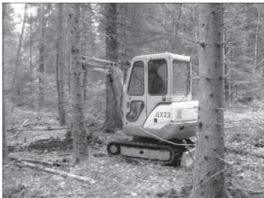
Fig. 8. För att skada miljön så lite som möjligt användes en liten grävmaskin med gummilarver vid schaktningen. Foto: Betty-Ann Munkenberg.
