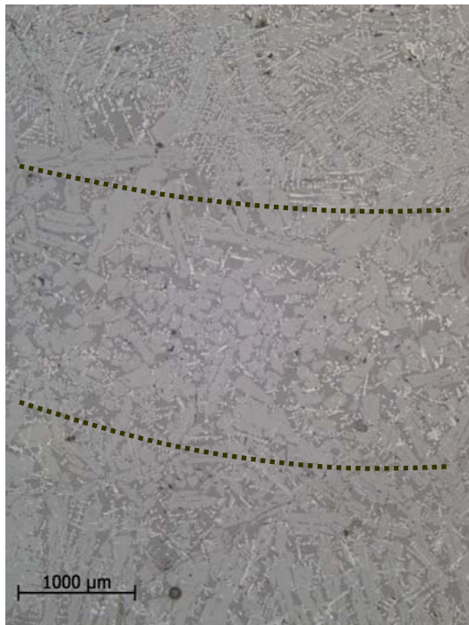
Figur 21. Fnr 62. Delar av slaggen där tre olika skikt kan anas med hjälp av skillnader i mineralproportioner och kornstorlekar.
