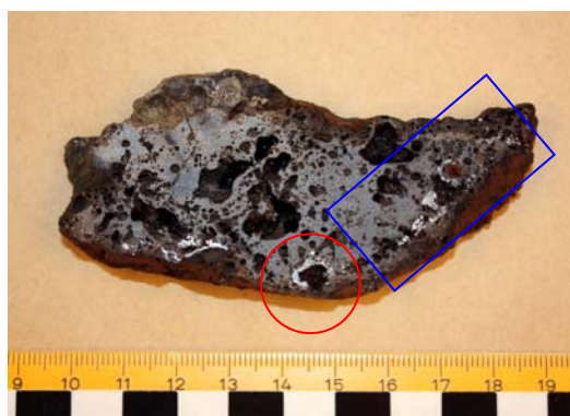
Figur 14. Fnr 55. Tvärsnitt av slaggen med ansamling av metalliskt järn i nedre delen (glänsande) i för övrigt homogen slagg. I den blå rutan har slaggen undersökts i mikroskop och i det rödmarkerade området har järnet analyserats.
