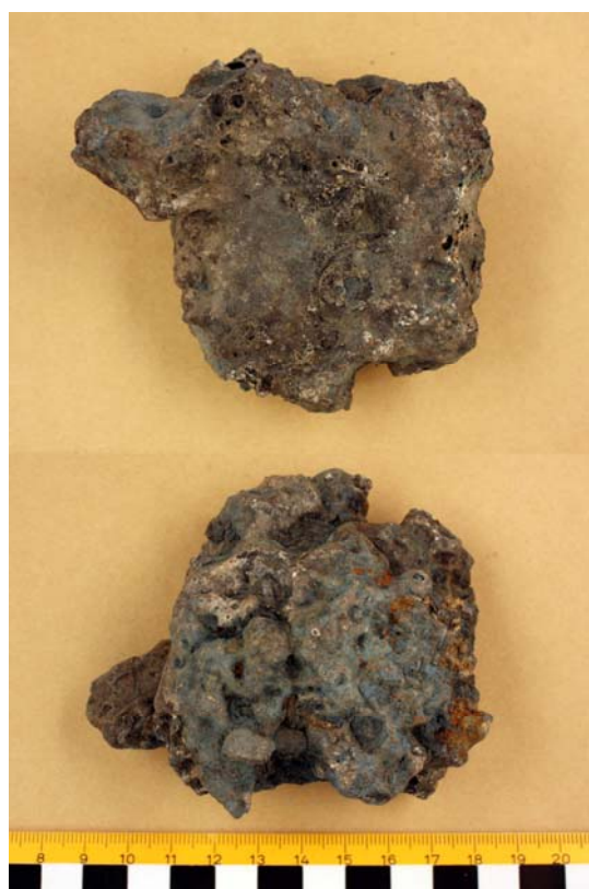
Figur 8. Fnr 50. Bottensidan av slaggen nederst och överytan överst. I övre delen syns en tydligt glasig yta.
