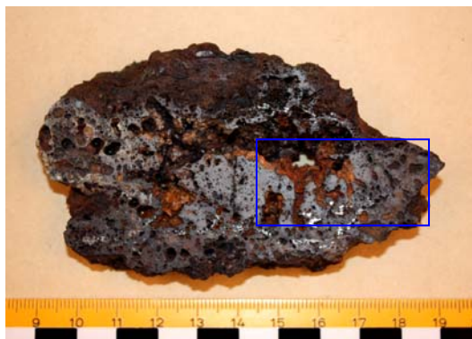
Figur 2. Fnr 41. Tvärsnitt av slaggen med ansamling av metalliskt järn i nedre delen (glänsande) i för övrigt homogen slaggg. Det undersökta provet är schematiskt utmärkt.
