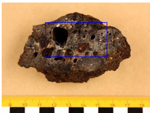
Figur18 . Fnr 61. Tvärsnitt genom slaggen med det undersökta provet markerat.
