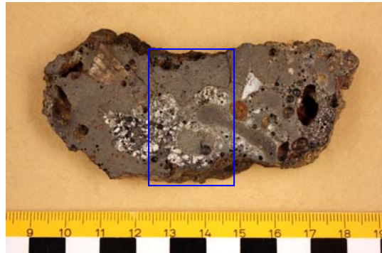
Figur 16. Fnr 56. Tvärsnitt genom slaggen med det undersökta provet markerat.
