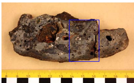
Figur 12. Fnr 54. Tvärsnitt genom slaggen med det undersökta provet markerat.
