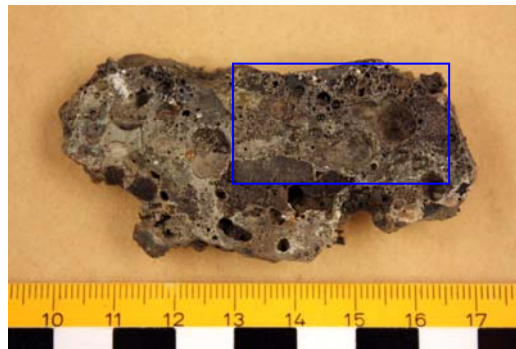
Figur 9. Fnr 50. Tvärsnitt genom slaggen. Det undersökta provet är schematiskt utmärkt.
