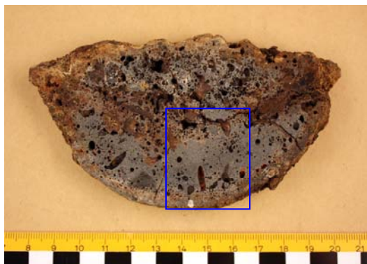
Figur 5. Fnr 49. Tvärsnitt genom slaggen. Det undersökta provet är schematiskt utmärkt.
