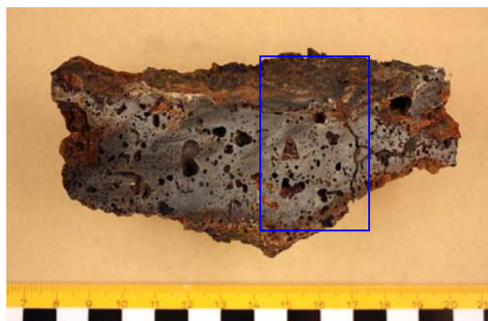
Figur 3. Fnr 43. Tvärsnitt genom en homogent uppbyggd slagg. Det undersökta provet är schematiskt utmärkt.
