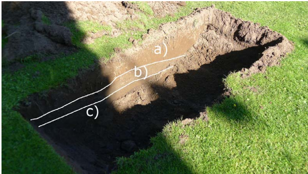
Bild 3. Foto över provschakt 1, där lagerföljden omfattade a) ett påfört sandhaltigt myllalikt matjordslager av skiftande djup (0,4 - 0,5 m) som i de flesta fall överlagrade ett b) påfört lager med mjåla, lera och svagt inslag av sand (ca 0,1 - 0,25 dm; uttolkat som "spärrlager" för att motverka urlakning av finare yttjord som påförts. Lagret följdes av c) blandade fyllnadsmassor (sand, grus, lerblandning, mjåla, litet inslag tegelflis, sten m m).
