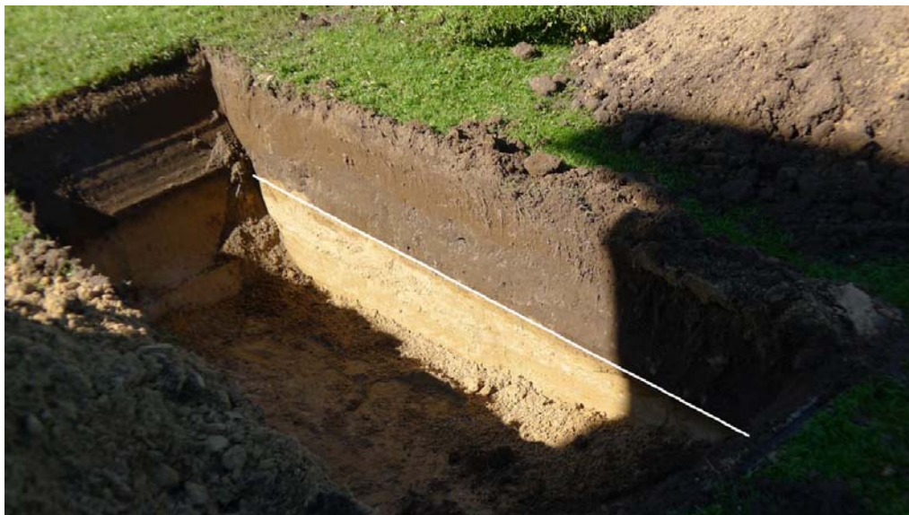
Bild 3. Foto över provschakt 1, där lagerföljden omfattade a) ett påfört sandhaltigt myllalikt matjordslager av skiftande djup (0,4 - 0,5 m) som i de flesta fall överlagrade ett b) påfört lager med mjåla, lera och svagt inslag av sand (ca 0,1 - 0,25 dm; uttolkat som "spärrlager" för att motverka urlakning av finare yttjord som påförts. Lagret följdes av c) blandade fyllnadsmassor (sand, grus, lerblandning, mjåla, litet inslag tegelflis, sten m m).
