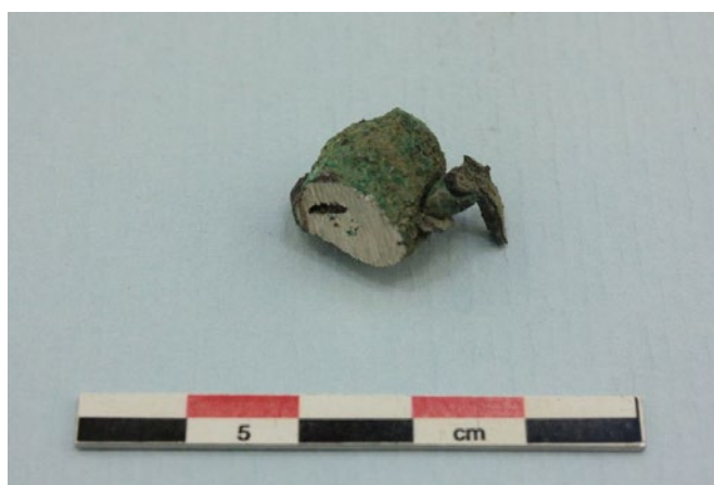
F512. Smältdroppe B, delad, från ugnsväggen.
