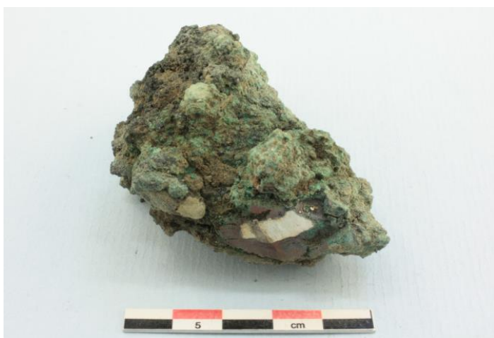
F567. En av de större smältorna i fyndmaterialet. Sågat tvärsnitt (metallyta) där prov tagits för analys.
