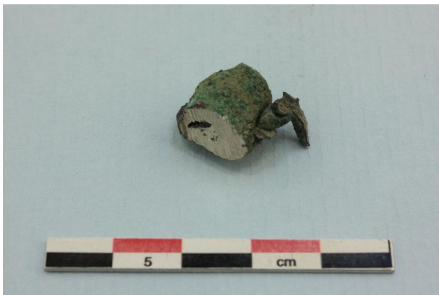
Figur 1. F512. Smältdroppe B, från ugnsväggen. Droppen är delad för analys och tvärsnittet visar den karaktäristiska bronzen.
