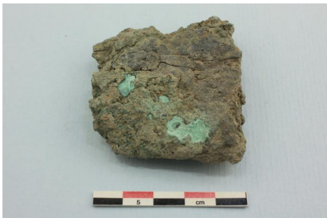
F568. Metallsmälta som stelnat mot en plan begränsningsyta. Ett prov från ytterkanten är analyserat.
