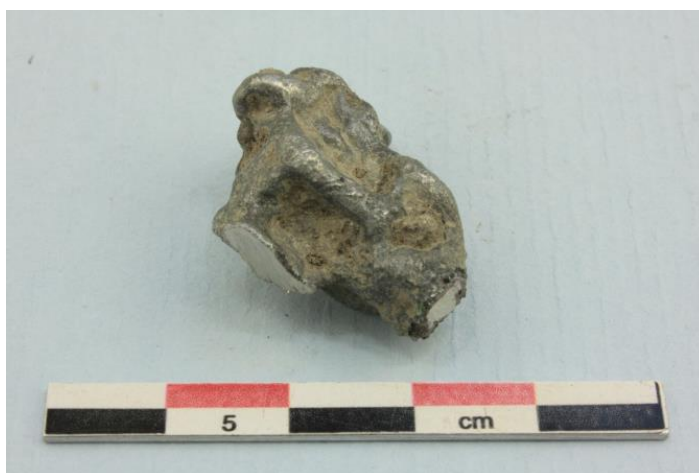
F564. Smälta med en yta som är ljus jämfört med de vanligen mer ärggröna som finns i fyndmaterialet. Tvärsnittsytan till höger (A), är något gulare än ytan (B) till vänster som är blekare.
