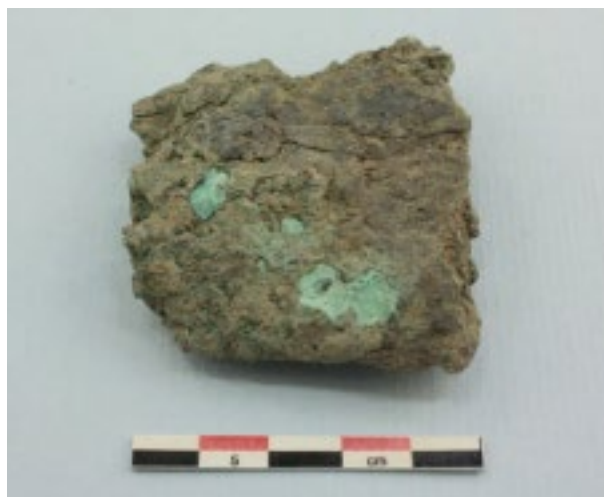
F568. Metallsmälta av brons från klockgjutning som stelnat mot en plan begränsningsyta.
