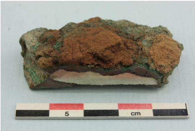
F570. Smälta som stelnat mot rödbränt keramiskt material. Delar av tvärsnittet har analyserats.
