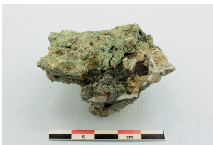
F569. Oregelbunden smälta som utöver den karaktäristiska ärggröna färgen har en ovanligt ljus metallisk yta som kan ses längst till höger. Provet för analys har tagits i det delade tvärsnittet.
